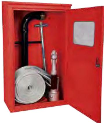
Cassetta in acciaio zincato SP 10/10, verniciata con polveri epossidiche per esterno rosso RAL 3000, corredata di collo di cigno Dn 70 con uno sbocco UNI 70, chiave telescopica, lancia a 3 effetti UNI 70 modello "LW70", manichetta UNI 70 a norma UNI 9492 con raccordi UNI 804 e legature UNI 7422.
