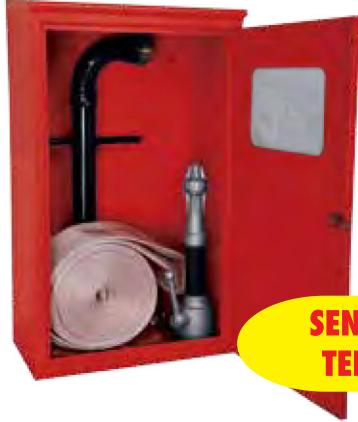
Cassetta in acciaio zincato SP 10/10, verniciata con polveri epossidiche per esterno rosso RAL 3000, corredata di collo di cigno Dn 70 con uno sbocco UNI 70, lancia a 3 effetti UNI 70 modello "LW70", manichetta UNI 70 a norma UNI 9492 con raccordi UNI 804 e legature UNI 7422.
