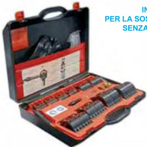
Il kit consente di congelare tutti i tipi di liquidi, inclusi quelli ad alta pressione, all'interno di tubazioni in acciaio, rame, alluminio o plastica.
