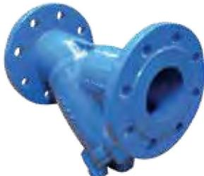
Filtro a Y con spurgo flangiato PN 16 - corpo in ghisa GJL500 Pressione massima di esercizio: PN16. Temperatura massima di esercizio: -10°C + 120°C Flangia: UNI - EN 1092.
