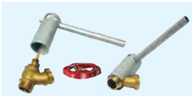
Una volta smontato il volantino del rubinetto, la chiave di presa calza e si adegua alla quasi totalità dei rubinetti prodotti ed installati. La presa che si effettua sul rubinetto, viene fatta sul corpo dello stesso senza andare a toccare i filetti, cosa importantissima, perchè se rovinati possono compromettere il collegamento con le tubazioni.
