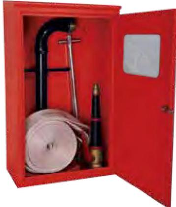
Cassetta in acciaio zincato SP 10/10, verniciata con polveri epossidiche per esterno rosso RAL 3000, corredata di collo di cigno Dn 70 con uno sbocco UNI 70, chiave telescopica, lancia a 3 effetti UNI 70 modello "MISTRAL", manichetta UNI 70 a norma UNI 9492 con raccordi UNI 804 e legature UNI 7422.
