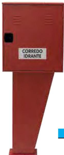
Costruite in acciaio zincato e verniciate a base di resine poliesteri speciali per esterni che ne garantiscono un'elevata resistenza alla corrosione, anche in ambienti marini (ISO 9227). Le cassette vengono fornite complete di adesivo di identificazione e sigillo di chiusura numerato.
