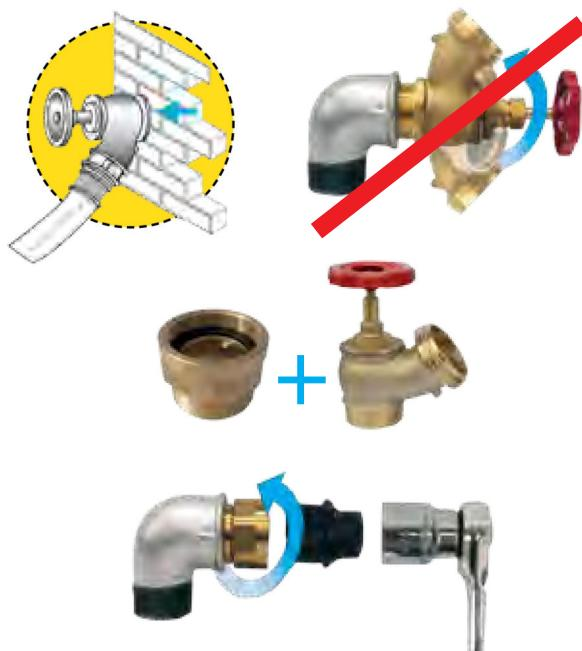
Montaggio della ghiera girevole tramite apposito perno in acciaio, utilizzabile con le chiavi a bussola universali. Avvitare la ghiera al raccordo.
